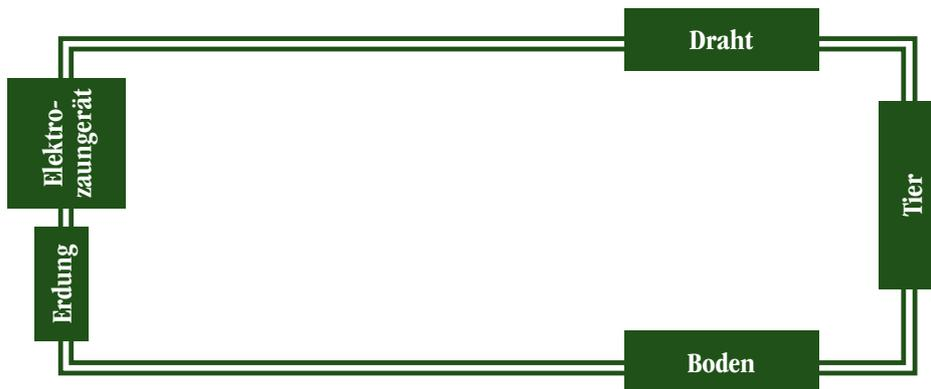
Abb. 2: Der Stromkreislauf wird geschlossen, wenn das Tier den Zaunleiter berührt.
